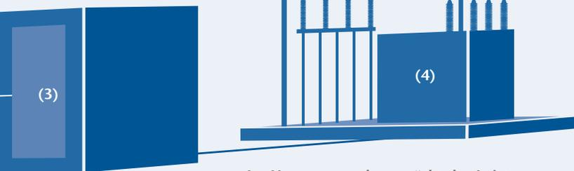
Im Umspannwerk verstärkt der Leistungstransformator (4) die 20 kV auf 110 kV, die über einen Stromzähler an das öffentliche Netz abgegeben werden.
